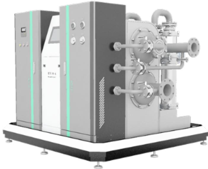
无负压变频供水设备投入使用。水管网中的水进入稳流水箱。罐中的空气从真空消除器排出。当水充满时，真空消除器自动关闭。当供水管网的压力能够满足用水需求时，系统通过旁路止回阀直接向供水管网供水；当供水管网的压力不能满足用水需求时，系统的压力信号通过远程压力表反馈给变频控制器，水泵运行，并根据用水量自动调节速度和恒压供水。如果运行的泵达到工频转速，它将启动另一个泵来运行变频。当由泵供水时，如果供水网络中的水量大于泵流量，则系统保持正常供水；在用水量高峰时，如果供水网络中的水量小于小泵流量，则稳流水箱中的水仍然可以提供正常的水作为补充水源。此时，空气从真空消除器进入稳流罐，罐中的真空被破坏。它
